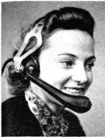
Fig. 2 x 3998 Huvudmikrotelefon under användning mikrofonarmen kan skjutas åt sidan när den ej användes; i fullt utskjutet läge bryter den mikrofonströmmen
