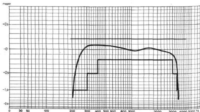
Fig. 30 Restdämpningskurva för 12 kaskad- kopplade kanaler i ett system
