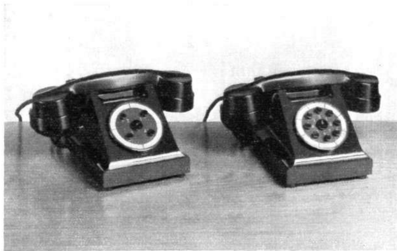
Fig. 1 X 5805 Bordapparater för hemtelefon t. v. DEK 9001 med fyra signalknappar, t. h. DEK 9002 med åtta signalknappar
