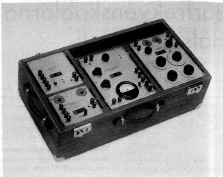
Fig. 2 Instrumentuppsättningens A-låda för skarvning av bärfrekvenskablarna i fält
